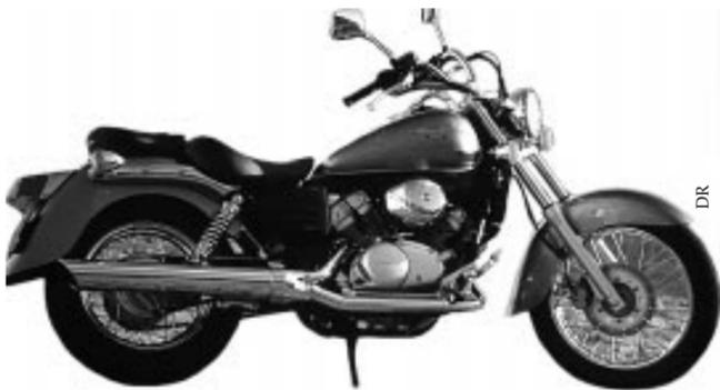
Très attachée à l'esthétique, la nouvelle clientèle de la moto apprécie les références au mythe du biker. Aussi la Shadow fait-elle le spectacle. Tout y est : platine d'instrumentation chromée posée sur le réservoir (compteur à affichage digital et chapelet de voyants), clé de contact près du carter du bicylindre en V incliné à 90 degrés, comme sur les Harley,
