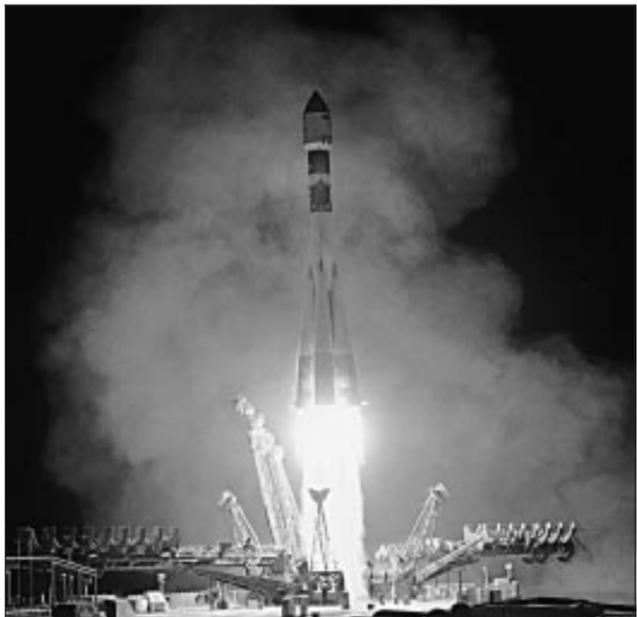
Au moment du décollage de Soyouz, les quatre bras de la « tulipe » s'ouvrent par simple effet mécanique.
