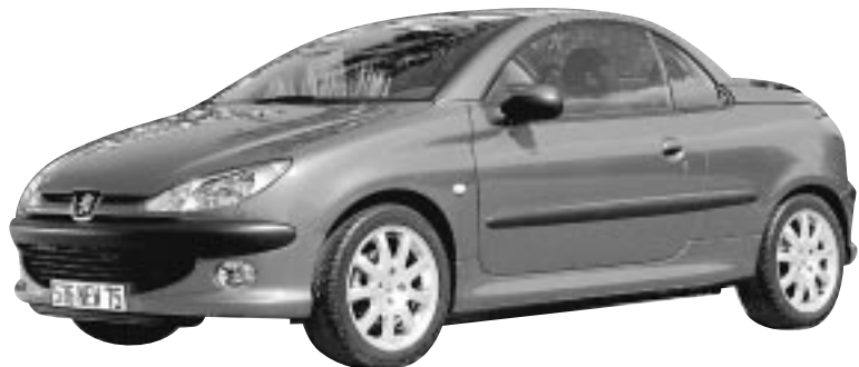
Pour passer de la version coupé (photo du bas), à la version cabriolet (photo du haut), il suffit, moteur tournant à l'arrêt, d'appuyer sur un gros bouton situé entre les deux sièges. En 20 secondes, le toit coulisse électriquement vers l'arrière, pour venir se ranger dans le coffre.
