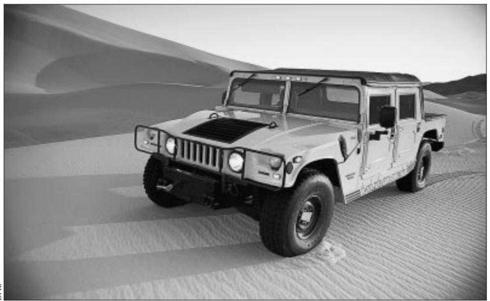
*Le Hummer, parallélépipède à peine dégrossi, peut escalader des pentes à 60 degrés, franchir des devers à 40 degrés, et traverser des gués de 80 cm. L'habitacle, évoque l'intérieur d'un blindé. Les sièges baquets assurent cependant un bon maintien, dans des conditions de confort satisfaisantes.*
