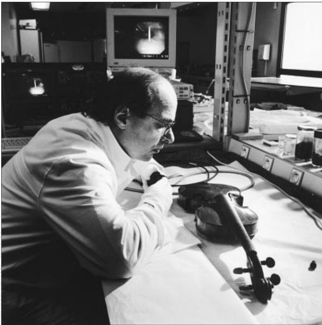
Joël Dugot, conservateur au Musée de la musique, réalise l'endoscopie d'un violon de Lambert datant de 1780, dans le laboratoire de recherche et de restauration du Musée de la musique.
