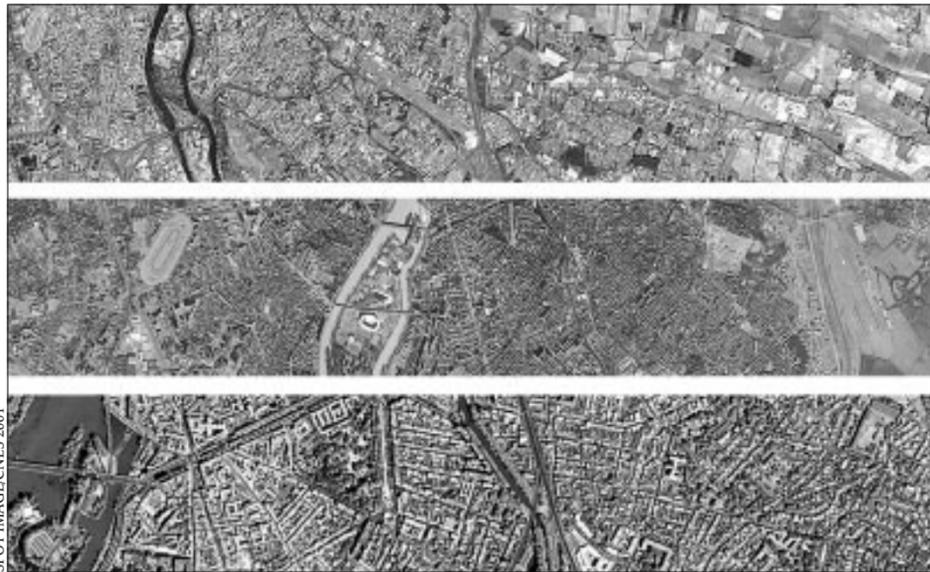
La capacité des satellites civils d'observation à prendre des images en orbite est étonnante. Ci-dessus, la ville de Toulouse prise avec des résolutions de 5 m et 2,5 m à la hauteur du pont Saint-Michel. Avec une résolution de 1 m, on peut distinguer les arbres tout comme, à droite, l'avion-espion américain retenu par les Chinois et filmé ici en avril par le satellite Ikonos.
