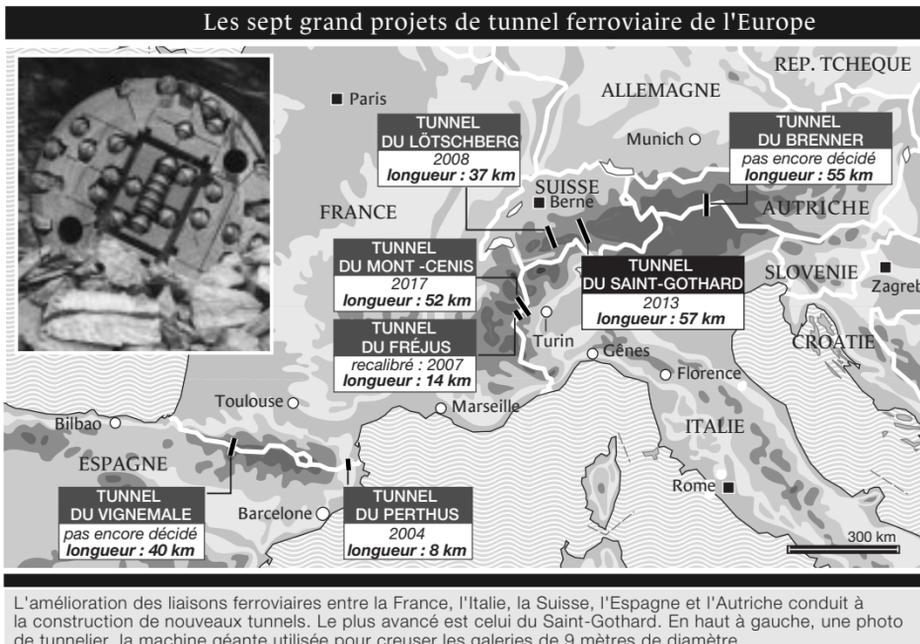
L'amélioration des liaisons ferroviaires entre la France, l'Italie, la Suisse, l'Espagne et l'Autriche conduit à la construction de nouveaux tunnels. Le plus avancé est celui du Saint-Gothard. En haut à gauche, une photo de tunnelier, la machine géante utilisée pour creuser les galeries de 9 mètres de diamètre.
