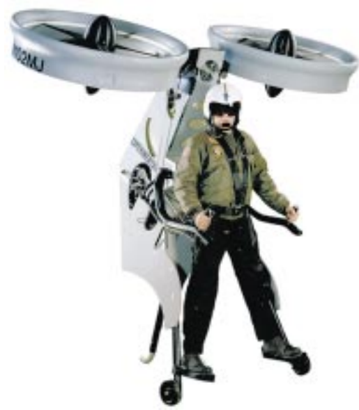
A gauche, le Solo Trek de Millennium Jet, qui devrait emporter dans les airs un soldat sur 250 km. Pour l'heure, il n'a fait des sauts de puce (30 cm) de quelques secondes, suspendu à une grue. A droite, vue d'artiste d'un soldat équipé d'un exosquelette imaginé par l'entreprise Sarcos.
