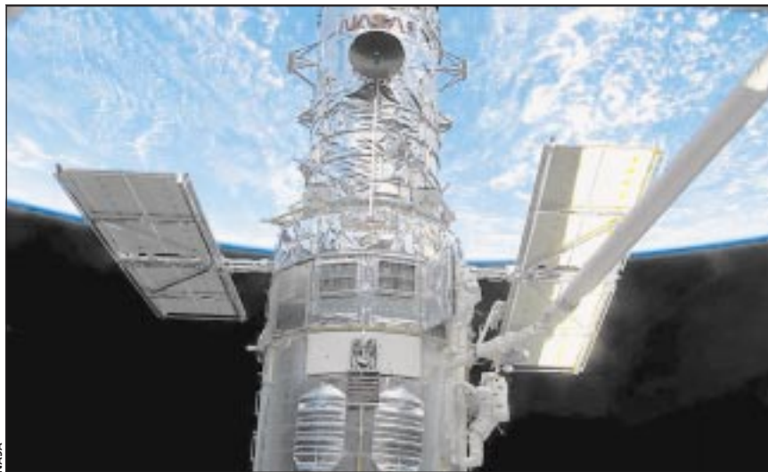
Au cours de leur dernière sortie dans l'espace, les astronautes américains ont notamment remplacé les deux panneaux solaires (photo) et changé le système électrique central. La mise à la retraite définitive de Hubble est prévue pour 2010.
