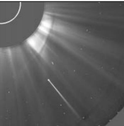
Sur cette photographie prise par l'un des coronographes de Lasco, le Soleil est masqué par un disque opaque (en haut à gauche). Le cercle blanc matérialise l'emplacement exact de notre étoile. Cette éclipse artificielle permet d'étudier la couronne solaire et, parfois, comme ici, de détecter une comète.
