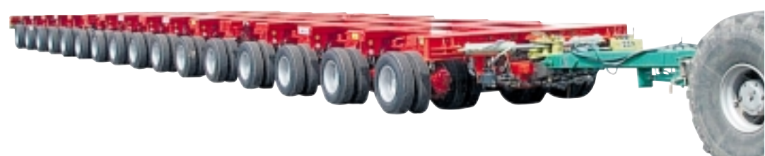
Les palettes des pièces de l'Airbus seront chargées sur des véhicules et des remorques de 25 à 28 mètres de long, véritables mille-pattes à 48 ou 96 roues, aux essieux directionnels et à suspension hydraulique.
