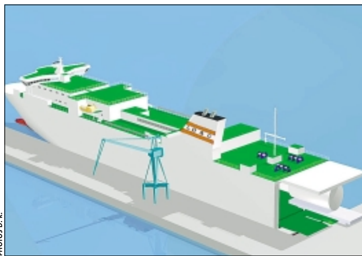
Le transport des éléments de l'A-380 se fera grâce à un « bateau-garage », qui desservira l'ensemble des quatre sites de production de l'appareil.
