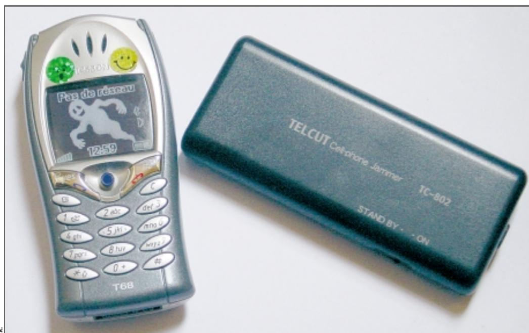
Des mini-brouilleurs GSM 900/1800 MHz de la taille d'un téléphone mobile, actifs de 5 m à 10 m à la ronde, sont disponibles en vente libre pour une centaine d'euros dans les boutiques d'électronique de Tokyo. D'autres brouilleurs, plus imposants, plus puissants et plus chers (de 200 à 1 000 €) permettent de couvrir une zone de plusieurs dizaines à plusieurs centaines de mètres carrés.
